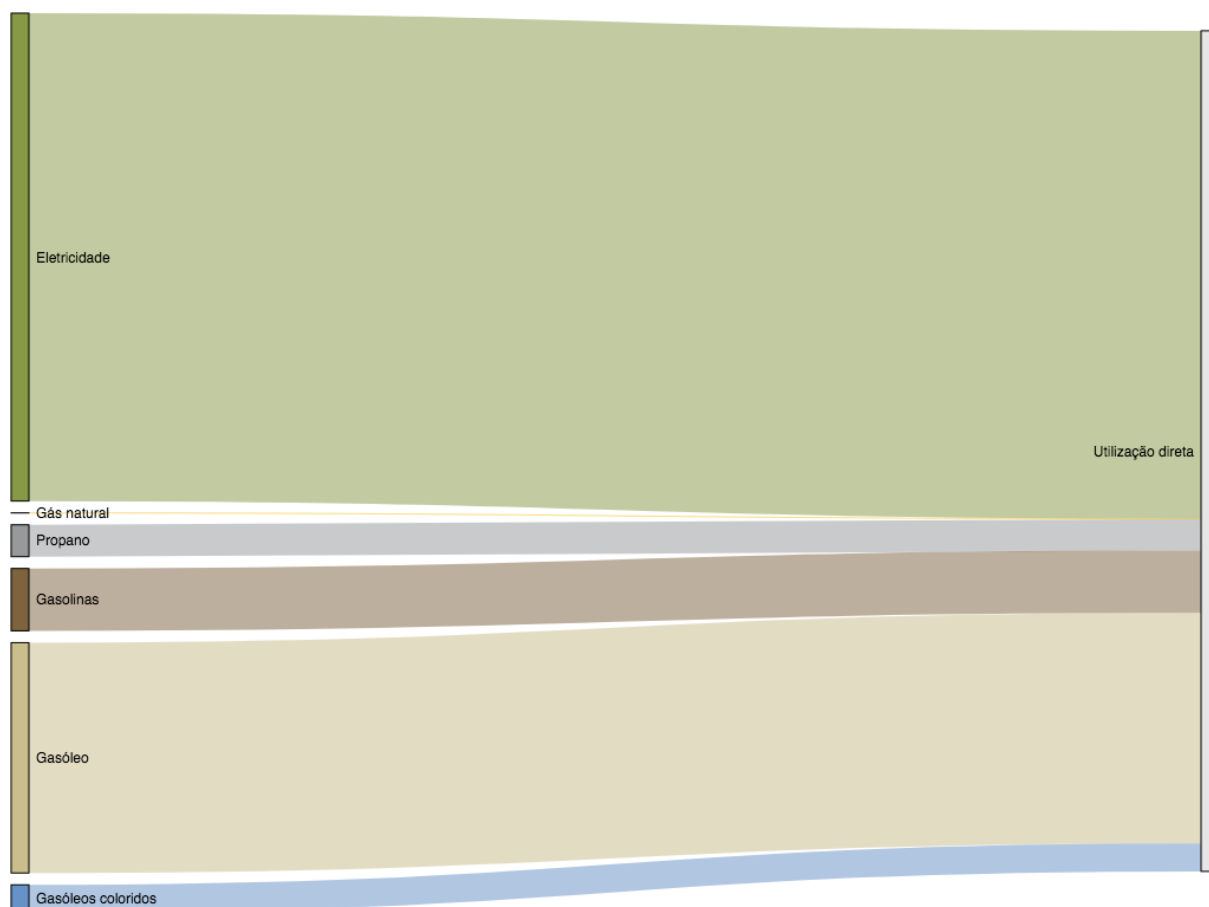
Figura 36: Diagrama de Sankey da utilização de fontes de energia primária no Município de Crato
