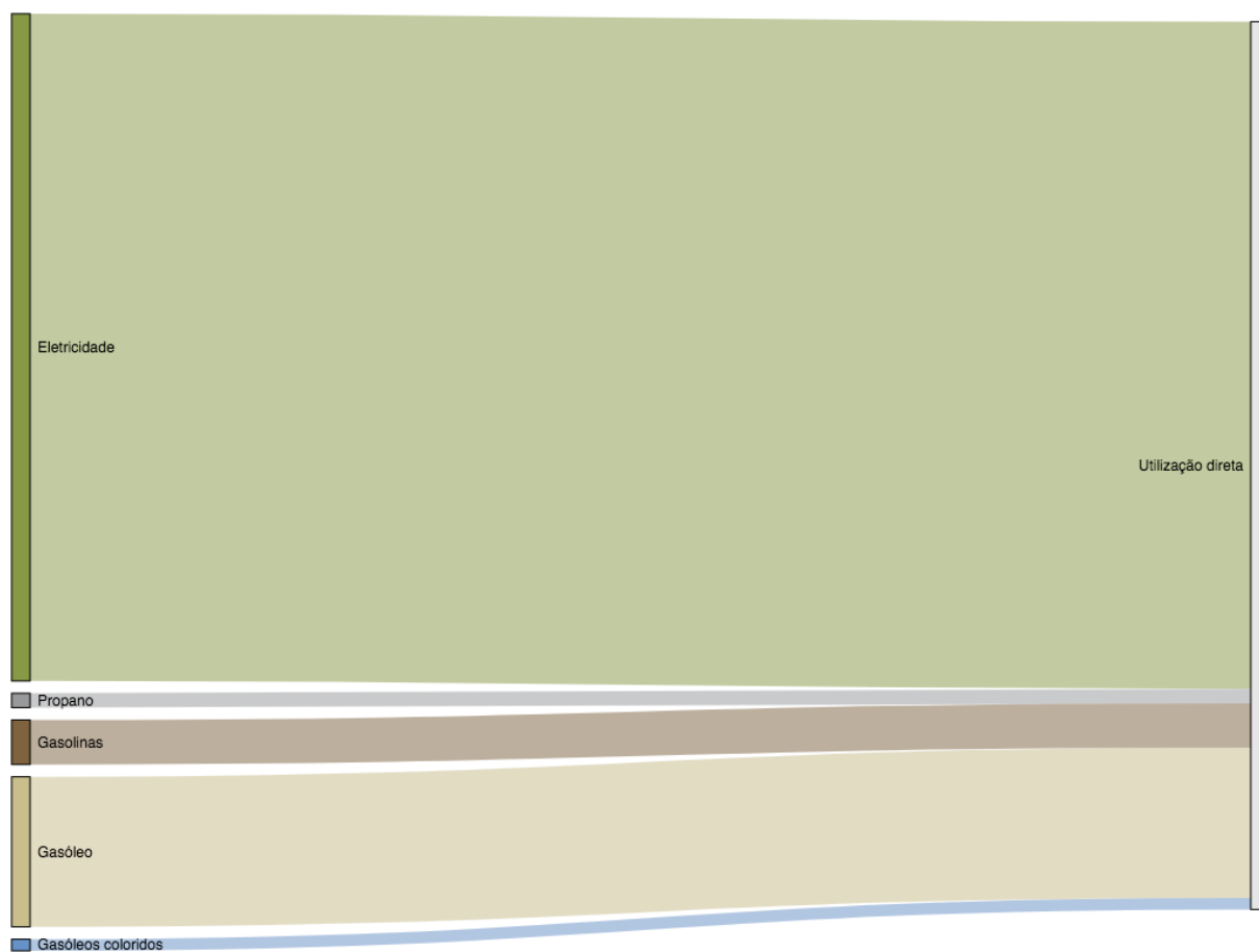
Figura 36: Diagrama de Sankey da utilização de fontes de energia primária no Município de Monforte
